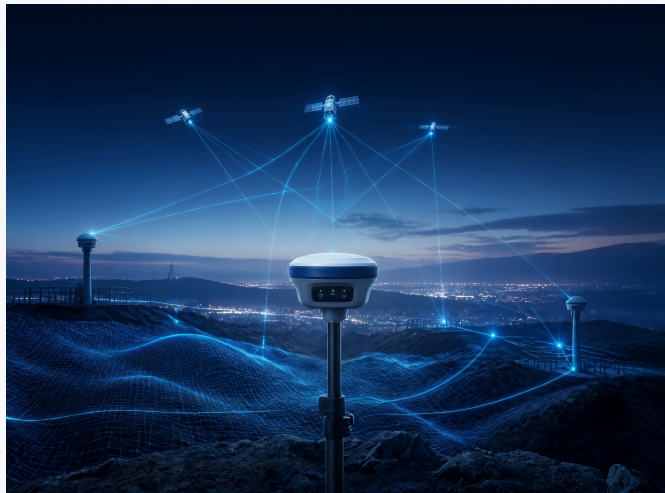
Servizio Network RTK / VRS
