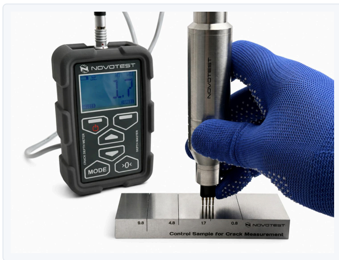
Misura della Profondità delle Cricche
