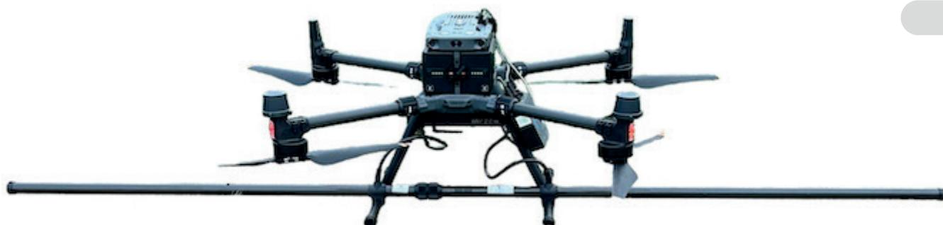
Il sistema **UAV Magnetometer R4-M350** è un magnetometro ultra-portatile progettato per essere **integrato su droni**, in particolare sul DJI Matrice 350 RTK (M350) o per l'**utilizzo a mano**. Questo sistema è ideale per eseguire rilievi su vaste aree ottimizzando i tempi di rilievo rispetto ai rilievi terrestri grazie alla funzione PPS, attivabile con il modulo uBlox.
