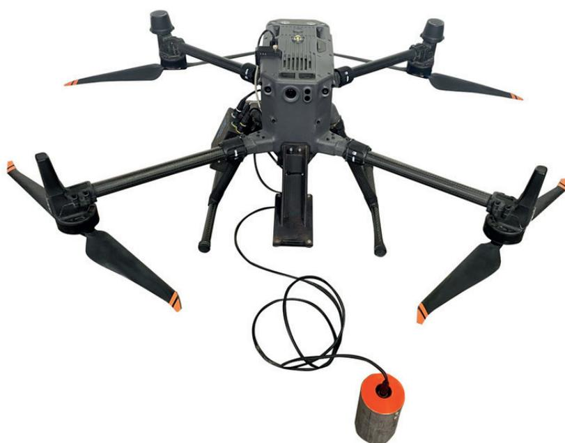
**UAV Echosounder** è una soluzione avanzata per la batimetria aerea che integra l'ecoscandaglio multifrequenza Echologger ECT-DO52S (o altri modelli compatibili) su droni UAV DJI. Questa tecnologia all'avanguardia consente di effettuare **rilievi idrografici precisi** in aree difficilmente accessibili, ottimizzando tempi e costi operativi.
