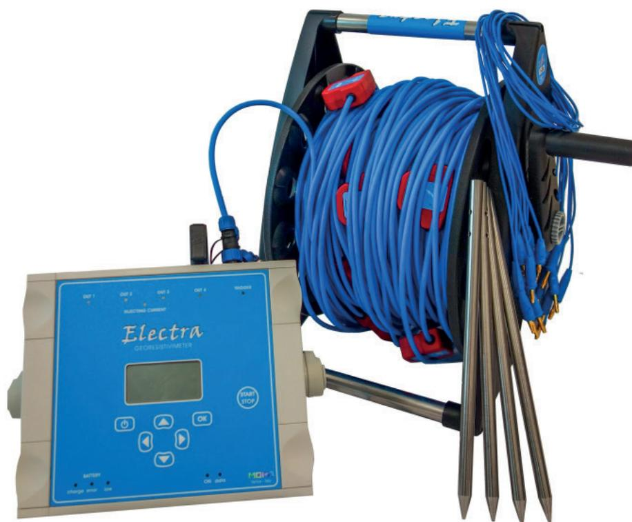
**Electra** è il **sistema digitale per i sondaggi elettrici in resistività e polarizzazione indotta**. Una serie di caratteristiche la rende un prodotto unico nel panorama dei georesistivimetri. I tempi di acquisizione sono abbattuti dall'acquisizione simultanea su tutti i canali della linea e dall'uso della corrente alternata.
