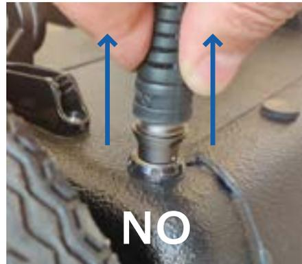
L'alimentazione del GPR si attiva quando il connettore DATA è collegato.
